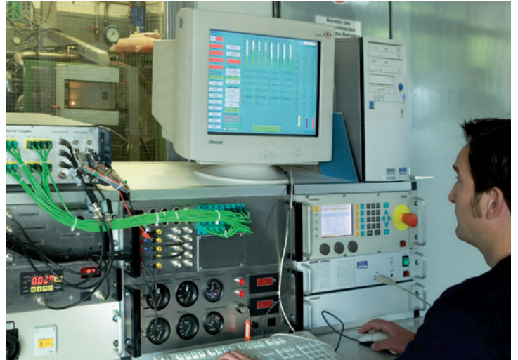
Auf Motorenprüfständen finden Vorentwicklungen statt, um für jeden Anwendungsfall die angemessene katalytische Beschichtung zu bestimmen.
