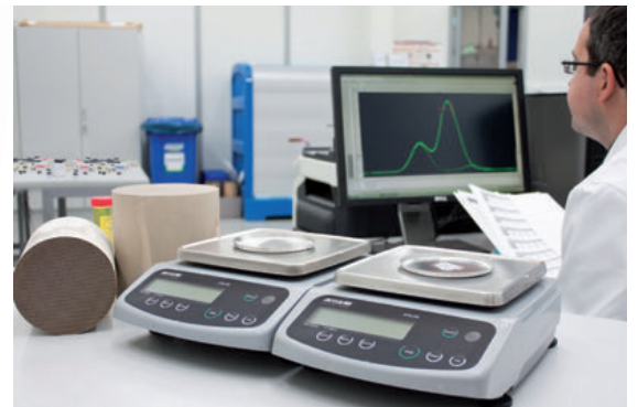
Vergleichsmessungen im HJS Labor – blu@mission ® - vs. Billig-Katalysator
