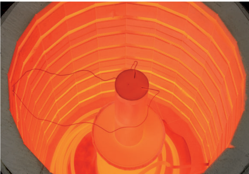
Künstliche Alterungssimulation im Hochtemperaturofen für den anschließenden Abgastest auf dem Rollenprüfstand gemäß Umweltzeichenanforderung
