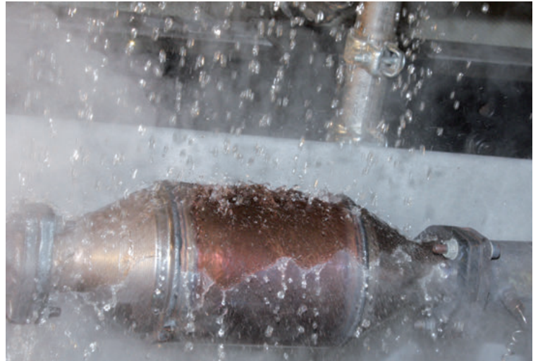
Temperaturwechselprüfung: Simulation von äußeren Einflüssen durch Spritzwasser und Thermoschocks im Inneren mittels schneller Temperaturwechsel „heiß/kalt“ der Strömungsluft (= Schubetrieb)
